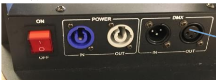
подключение машины через DMX-порт к др. машинам
